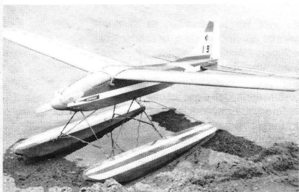
Bild 4: ČSSR-Modell KIWI (Schwimmerdecks in flacher Bauweise); Spannweite 1,40 m, halbsymmetrisches Profil, Startmasse 2,5 kg, Motor: MVVS 5,6 cm 3
